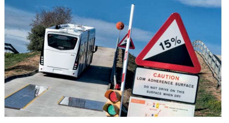
Otras zonas del circuito, como el adoquinado plano con ondulaciones, permiten al conductor detectar ruidos internos en el habitáculo del autocar y evaluar el confort tanto del conductor como de los pasajeros. Las ondulaciones del terreno de la pista (simétricas y asimétricas en ruedas izquierdas y derechas) ponen a prueba los sistemas de suspensión y ayudan a evaluar el confort en el interior del vehículo.
