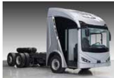
L'Irizar ie truck, un camion conçu pour différents usages industriels dans les villes et avec une vocation de mobilité électrique. Sa première application est le ramassage de déchets urbains. Les versions qui existent actuellement incluent les camions zéro émission ou avec extenseur de gamme à gaz ou HVO.
